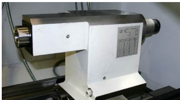
气动尾座 Mo. 5 Contre-poupée pneumatique Mo. 5 Pneumatic tailstock Mo. 5 0180-65200-001
