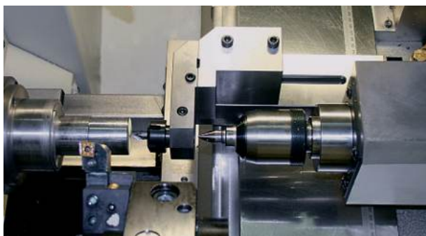
鞍座+后置对心工具架 Semelle + Porte-outil de centrage arrière Saddle + Rear centering tool holder 0180-59250-000 / 0180-59240-000
